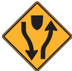
أمامك طريق سريع منقسم
