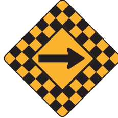
أمامك منحنى أو انحناء حاد في الطريق
