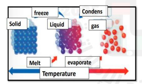
إضافة الطاقة في عملية الذوبان و االتبخير، تتحرك الجزيئات بسرعة Adding heat energy makes particles move faster Melting happens when solid goes to liquid by adding energy Evaporation happens when liquid goes to gas by adding energy
