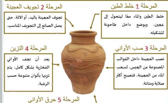
تجرق الأواني الفخارية داخل الأفران المخصصة لذلك، حتى تتماسك جيدًا ويسهل استخدامها، وهي من أهم مراحل صناعة الفخار، لأنها إذا فشلت تذهب مراحل صناعة الفخار السابقة في مهب الرباح.
