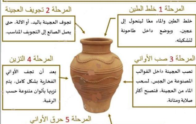
تحرق الأو اني الفخارية داخل الأفران المخصصة لذلك، حتى تتماسك جيدًا ويسهل استخدامها، وهي من أهم مراحل صناعة الفخار، لأنها إذا فشلت تذهب مراحل صناعة الفخار السابقة في مهب الرباح.
